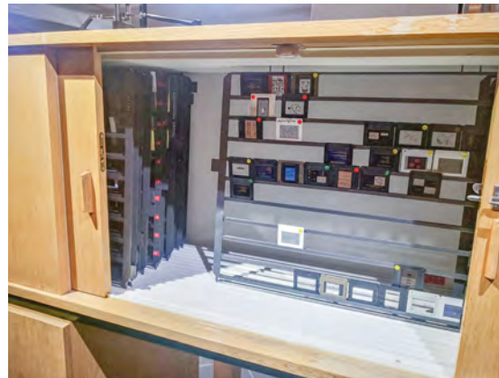
↑ Widok wnętrza po otwarciu głównych drzwiczek, ramki na przeźrocza przesuwają się wzdłuż szyn umieszczonych na ścianach dolnej i górnej szafki
