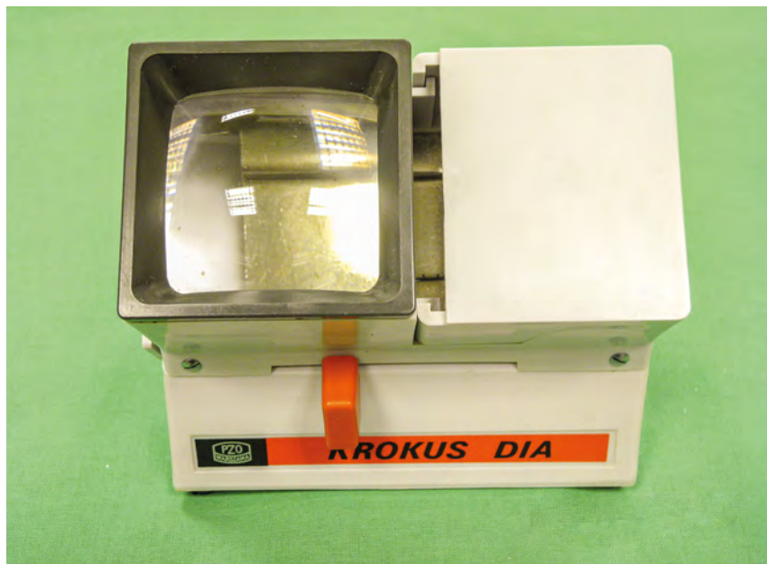
← Przeglądarka Krokus DIA, widoczny uchwyt do przesuwania ramki przeźrocza
