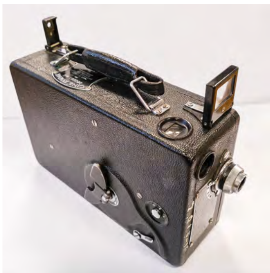
↑ Kamera Cine-Kodak Model B-B z boku, widoczny uchwyt mechanizmu nakręcania
