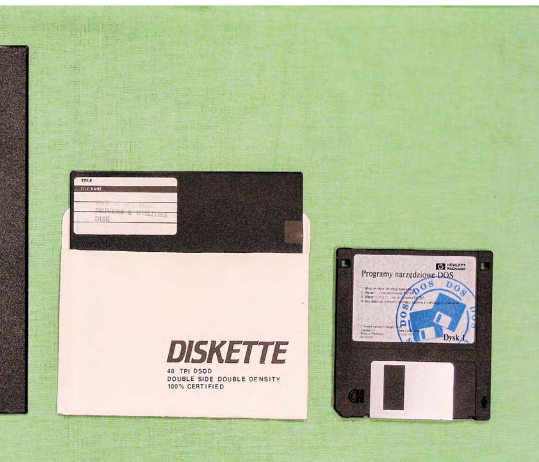
← Trzy dyskietki. Od lewej: o wymiarach 8 cali, 5,25 cala oraz 3,5 cala
