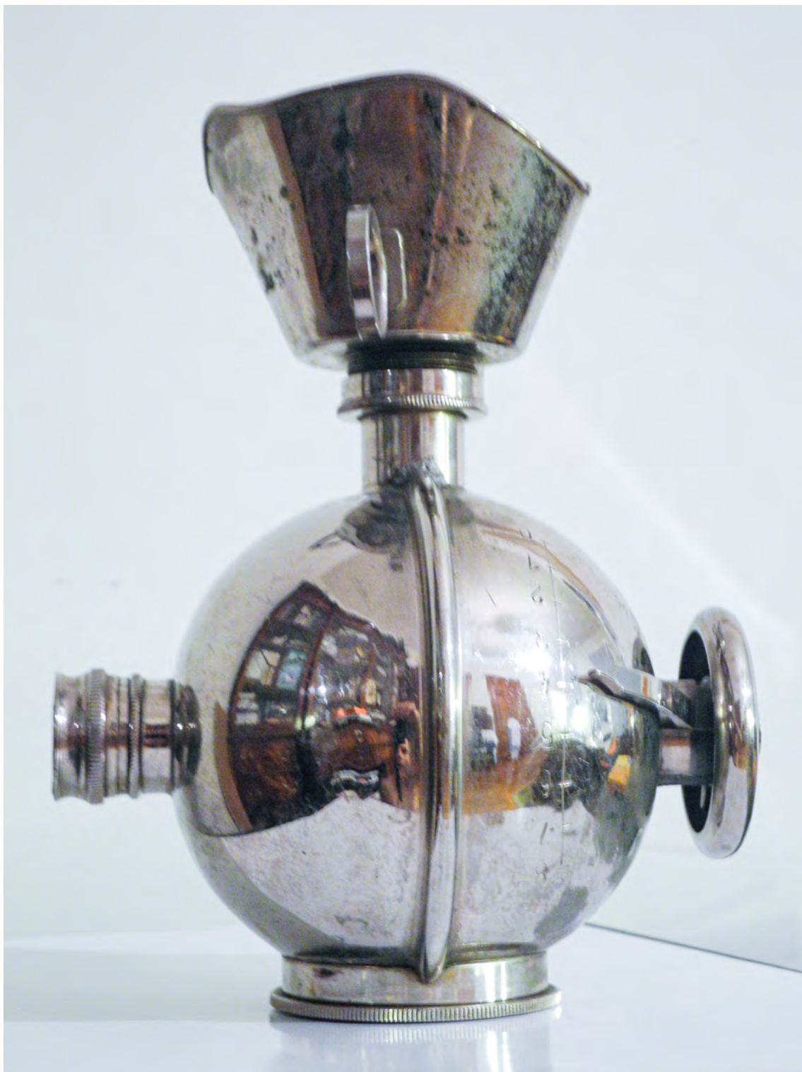
Widok z boku – po prawej pokrętło ze skalą do regulacji ilości podawanego eteru
