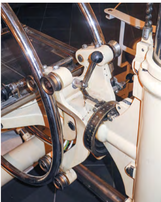
↑ Fragment mechanizmu obrotowego ramienia aparatu Lysholm z kolekcji Muzeum GUMed
