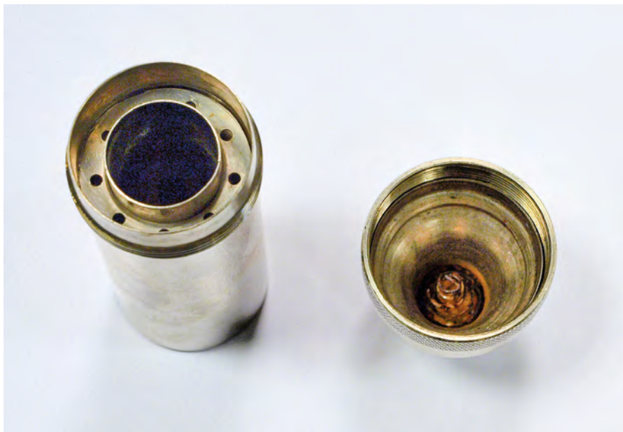
Paratus otwarty, widoczne miejsce na strzykawkę oraz gniazda na igły
