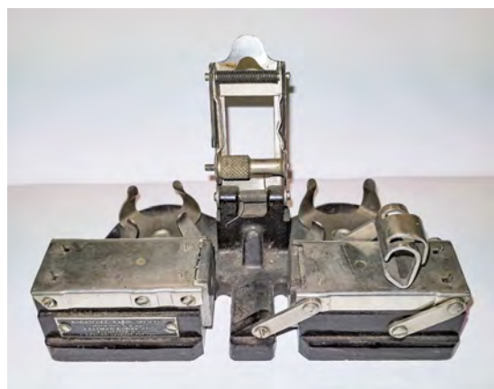
↑ Kodascope Rapid Splicer – urządzenie do montażu taśmy filmowej
