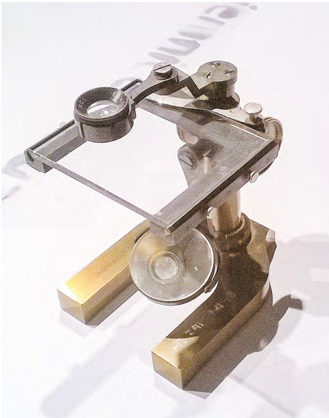
Mikroskop preparacyjny – widok od przodu i z góry. W lusterku służącym oświetlaniu preparatu odbija się lupa
