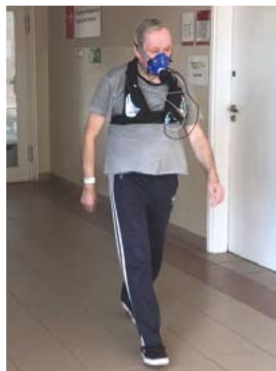
Rycina 7. Badanie spiroergometryczne podczas testu korytarzowego przy użyciu systemu mobilnego.
